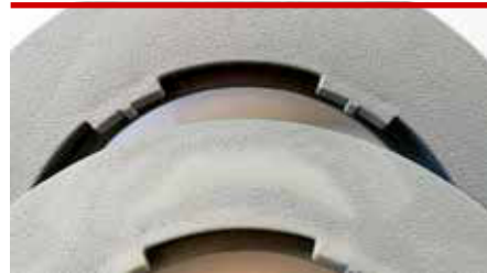
Adaptierte Qualitätssicherung vom Kleben auf das Kunststoffschweißen: Oben mit und unten ohne Qualitätsmaßnahmen in Anlehnung an die DIN 2304) (Bild: Toconus | Fachkompetenz Kleben)
