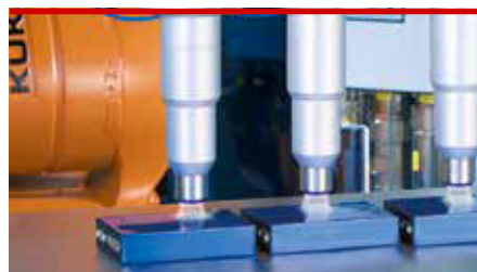
Plasmavorbereitung prismatischer Batteriezellen vor der Verklebung und Montage zum Batteriemodul (Bild: Plasmatrete GmbH)
