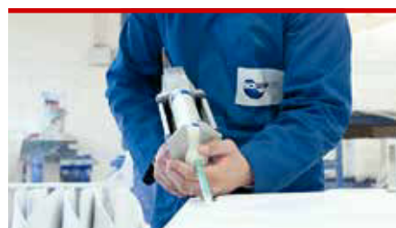
Verarbeitung von MMA-Klebstoffen mit nur minimaler Oberflächenvorbehandlung und schneller Aushärtezeit von 6 bis 8 min die über 35 MPa Zugfestigkeit erreichen können (Bild: SCIGRIP)
