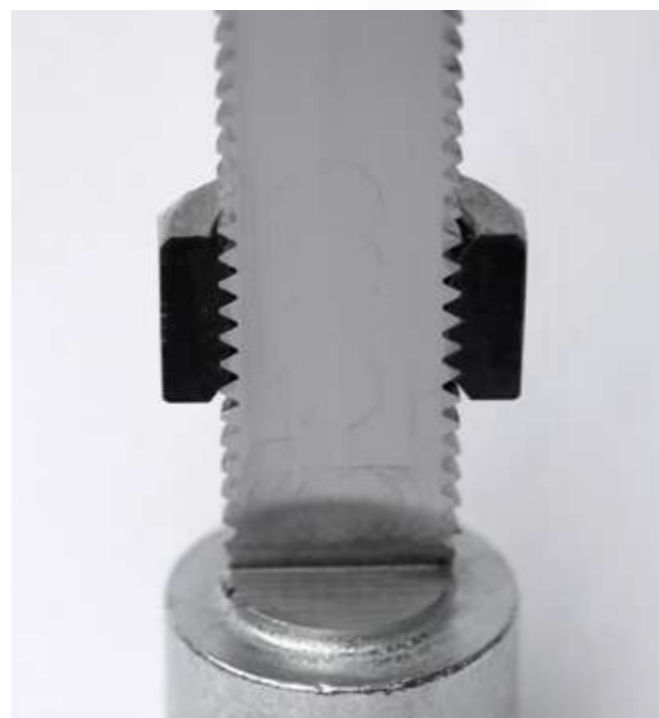
Die Aushärtung (Polymerisation) erfolgt durch Metallkontakt und Sauerstoffabschluss (anaerob).
