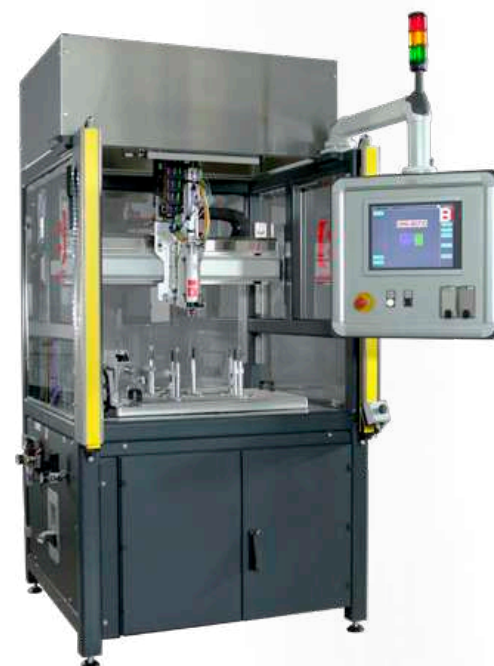
CNC-Compact z uchwytem na kartusz. Stanowisko do aplikacji szczeliwa w skrzyni biegów.
