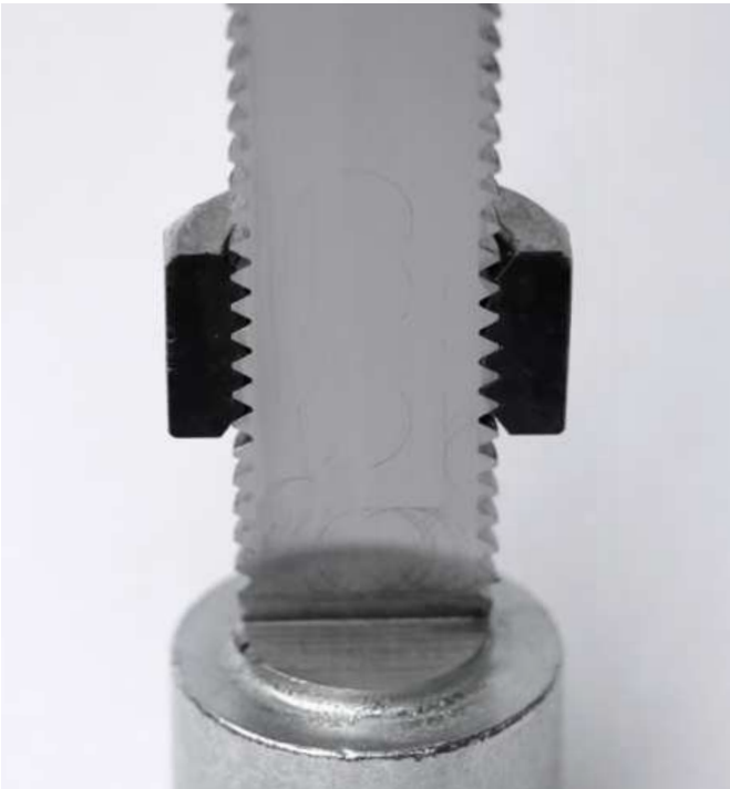
Utwardzanie (polimeryzacja) zachodzi podczas kontaktu z metalem i po odcięciu dopływu tlenu (utwardzanie anaerobowe).
